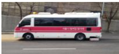
차량형 GPR(시도, 간선도로)
