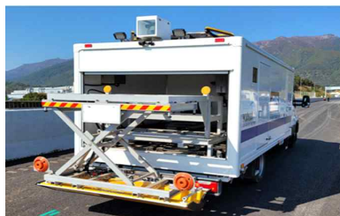
〈교면포장 GPR 조사장비〉
