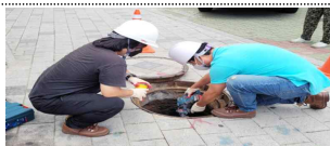
<맨홀 내 악취 측정>
