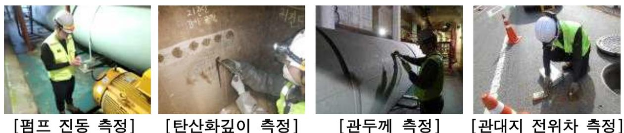
[펌프 진동 측정]      [탄산화깊이 측정]      [관두게 측정]      [관대지 전위차 측정]
