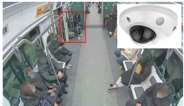
※ CCTV 칸당 4대 설치 사각지대 제거
